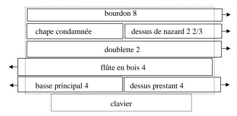
le bouton de tirage du bourdon 8 est à gauche, le mouvement est renvoyé à droite au moyen d'une tringle de bois
